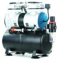
Der ölfreie Kompressor **KM 35** beinhaltet einen 3 Liter Tank und 2-Kolben, wodurch ein maximaler Druck von 6 bar erreicht werden kann.
