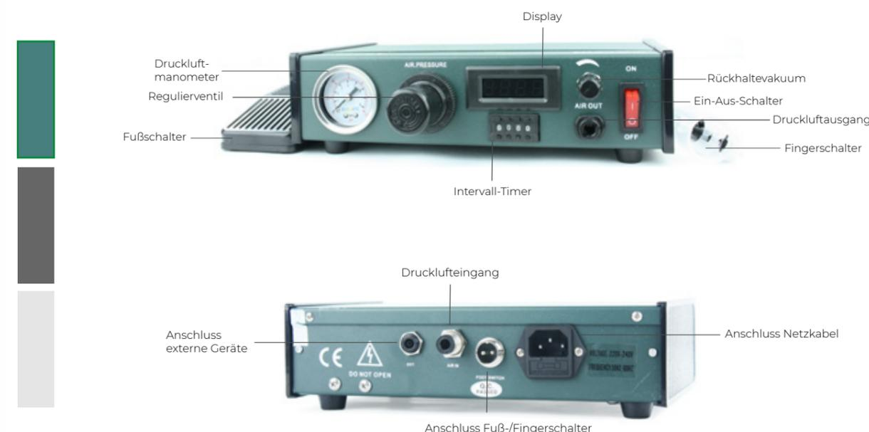
Bild 1: Digitales Dosiergerät DG 1000 T
