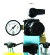
Der Materialdruckbehälter **MDG 4** mit Inhalt bis zu 2 kg ermöglicht eine kontinuierliche Arbeitsweise und verringert damit deutlich die Arbeitszeit für die Anfertigung von Domingartikeln.
