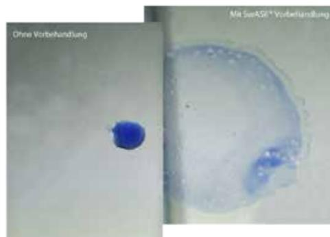
**Bild 1:** Effekt der Oberflächensilikatisierung auf Aluminium-Material.
