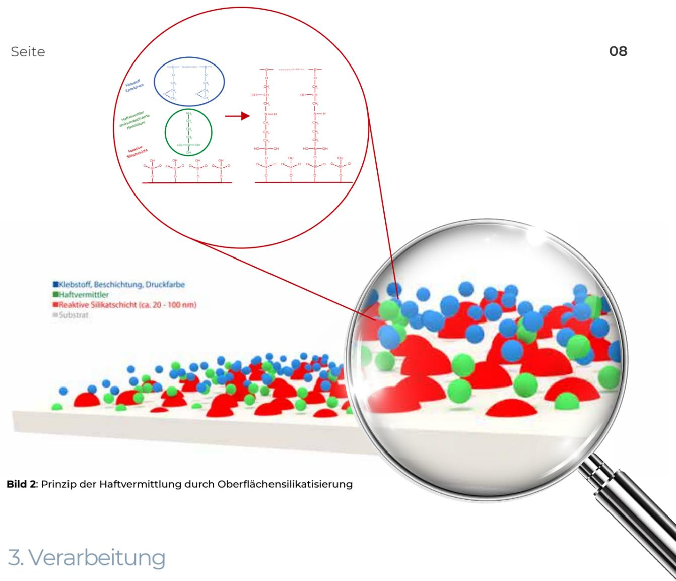
**Bild 2:** Prinzip der Haftvermittlung durch Oberflächensilikatisierung
