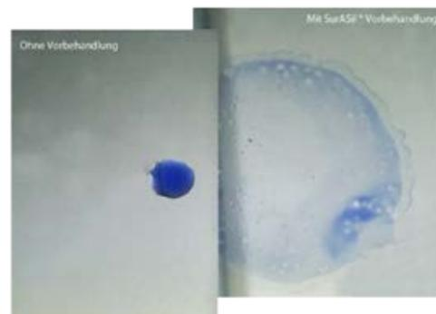
**Bild 1:** Effekt der Oberflächensilikatisierung auf Aluminium-Material.
