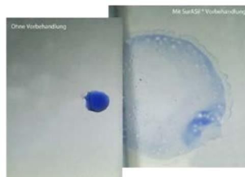
**Bild 1:** Effekt der Oberflächensilikatisierung auf Aluminium-Material.
