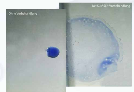
Bild 5: Effekt der Oberflächensilikatisierung auf Aluminium-Material.
