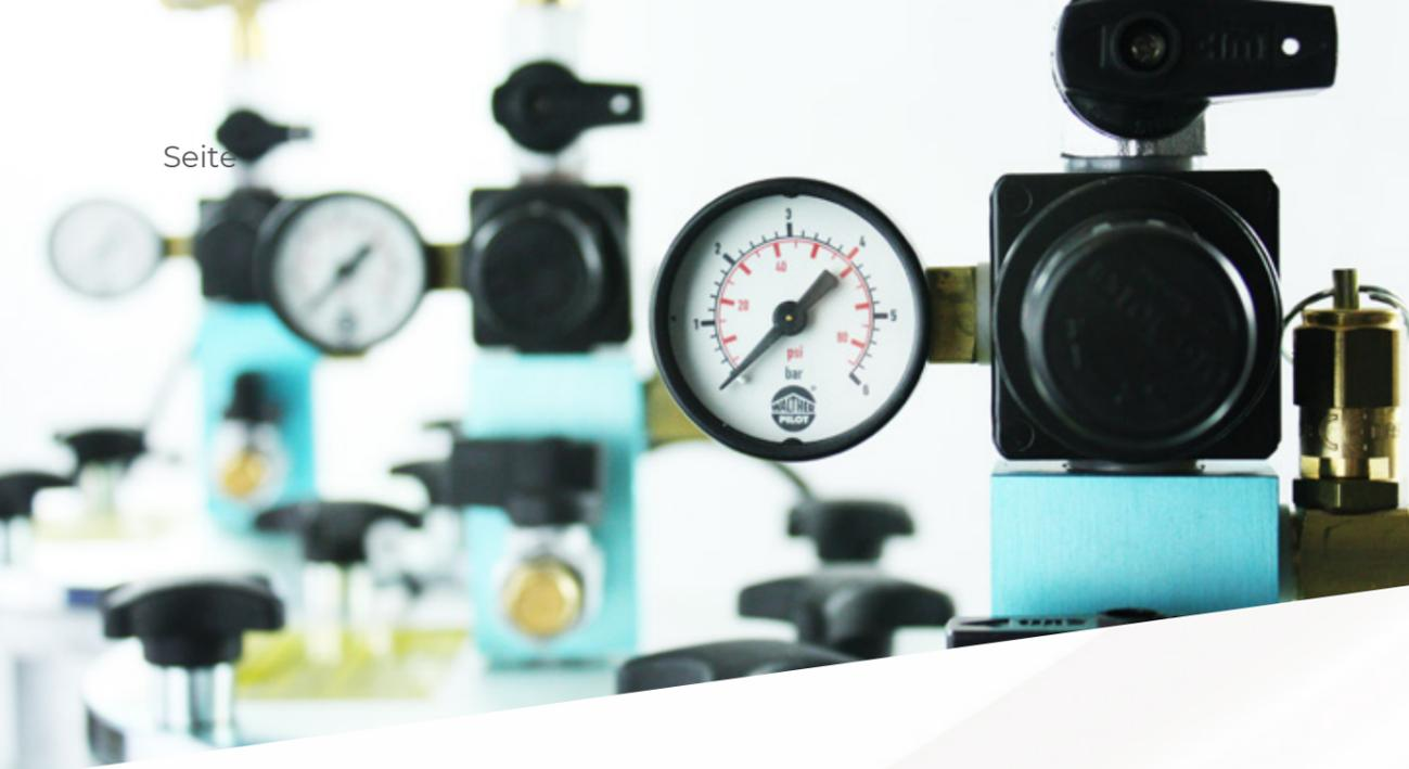
8. Öffnen des Druckreglers am Materialdruckbehälter (Drehgriff ziehen zum Entarretieren) und Regulierung des empfohlenen Materialdruckes am Druckregler (Bild 9), Linksdrehung - Druckverringerung, Rechtsdrehung - Druckerhöhung. Es wird ein Materialdruck von ca. 2 bar empfohlen.
